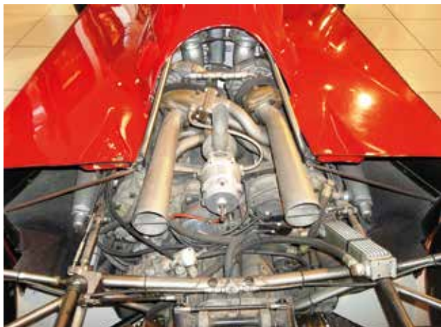
Motore Ferrari turbo compresso a 6 cilindri disposti a V, di 120° di 1500 cm 3 di cilindrata
